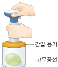
자료 분석 감압 용기를 이용한 압력과 부피 변화 실험
